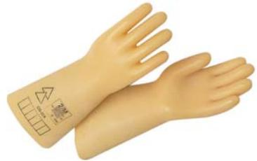
Les gants isolants doivent être vérifiés fréquemment, et, avant tout emploi, on doit s'assurer qu'ils sont en bon état et ne présentent ni traces de fissure, ni déchirures, ni trous même très petits. Tout gant présentant un défaut doit être retiré du service. Les gants isolants doivent être conservés dans des boîtes ou sachets de protection et ne pas être en contact avec des objets tranchants ou pointus, ni près d'une source de chaleur.
