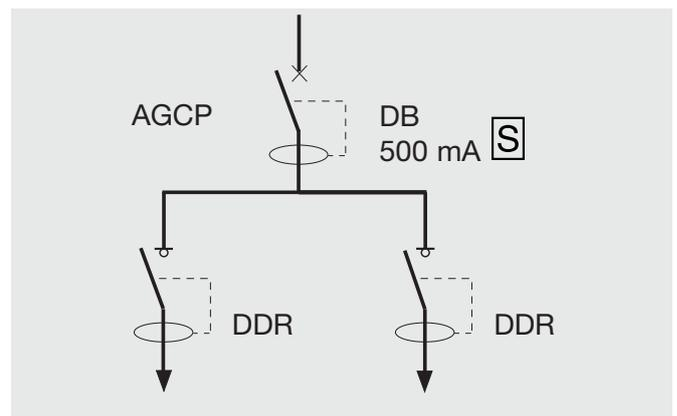
■ Lorsque le disjoncteur de branchement placé à l'origine de l'installation ne comporte pas cette fonction, des DDR 30 mA doivent protéger tous les circuits individuellement ou par groupe de circuit, et le tableau d'abonné doit être de classe II.
