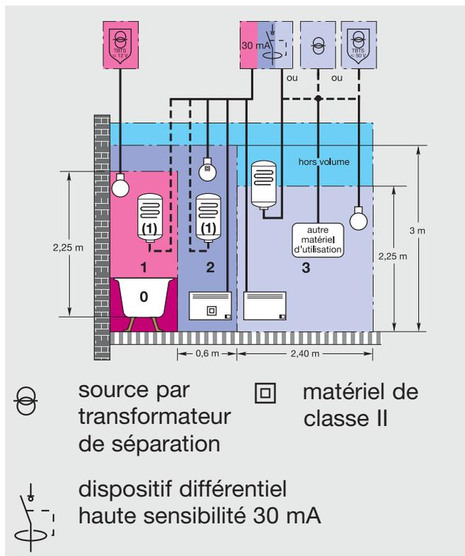
■ Lorsqu'un faux plafond ajouré est disposé dans le volume 2 (hauteur comprise entre 2,25 m et 3 m par rapport au sol), l'espace situé au-dessus de ce plafond, dans les dimensions du volume 2 est également assimilé au volume 2.
