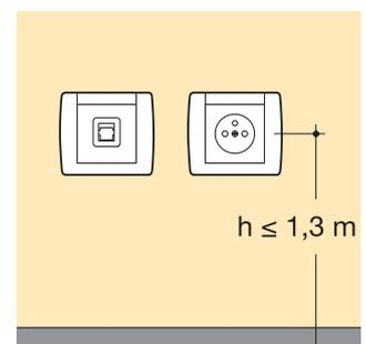
■ L'axe des socles de prise de courant ou des prises de communication doit être situé à une hauteur inférieure ou égale à 1,3 m du sol.
